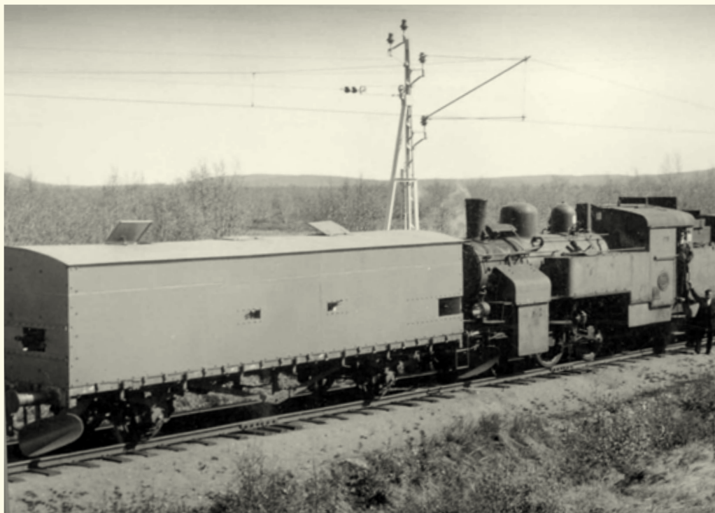
I överbyggnaden på vagnarna i pansartåget Kiruna var skottgluggarna försedda med pansarluckor på insidan. Ytterligare två pansartåg planerades, Östersund och Malmö, men byggdes aldrig.
