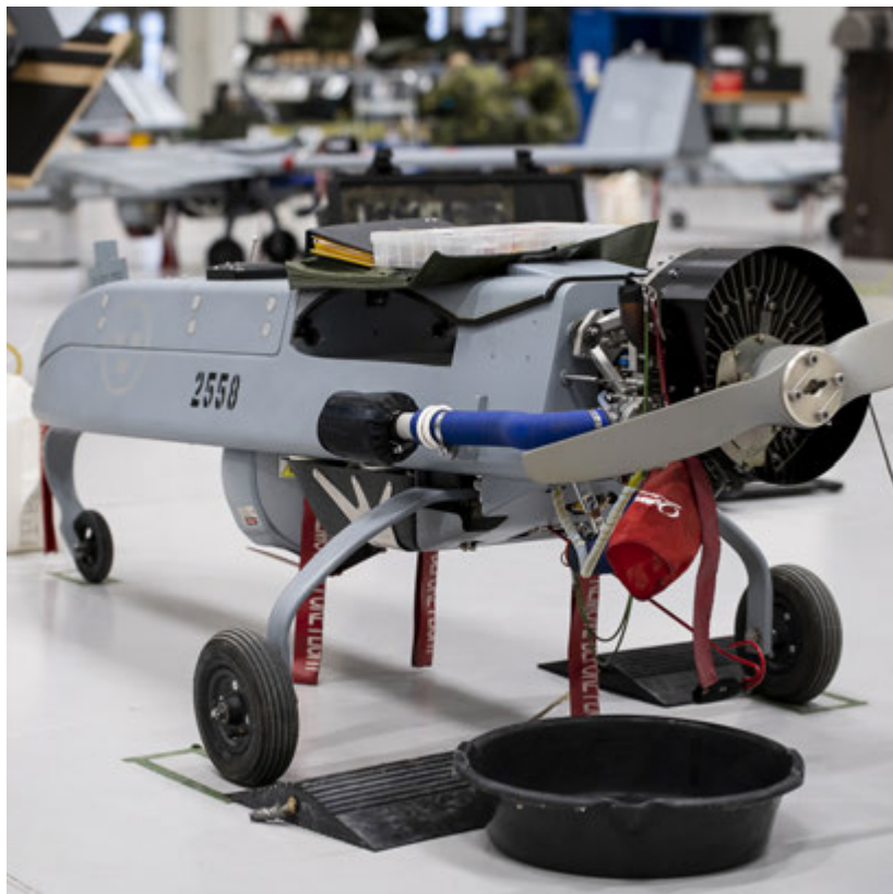
UAV 03 Örnens flyger på högoktanigt flygbränsle. Tankarna rymmer 44 liter och ger en räckvidd på tolv mil. Motorn är en wankelmotor på 38 hästkrafter.
