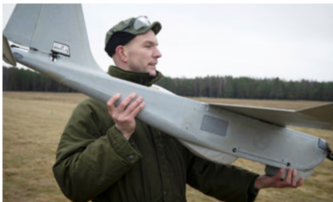
UAV 05, Korpen, SRPAS – kärt barn och så vidare – har en räckvidd på två mil och har flugit i Försvarsmakten sedan 2013.
