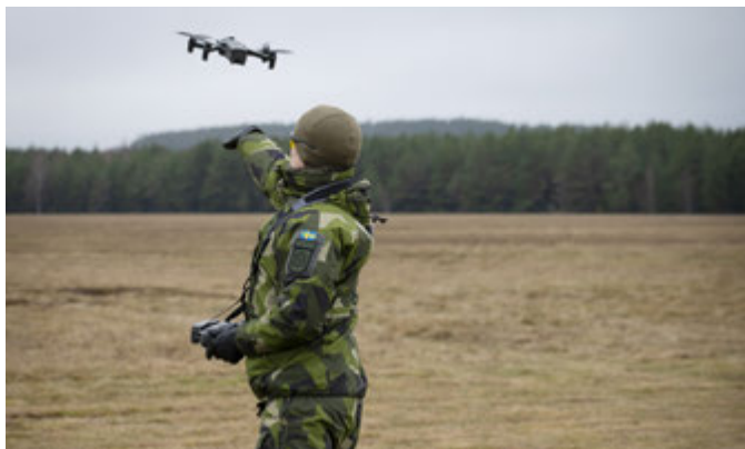
UAV 06 startas från handen, med handflatan uppåt och utsträckt arm. Quadrokoptern kommer från franska tillverkaren Parrot.
