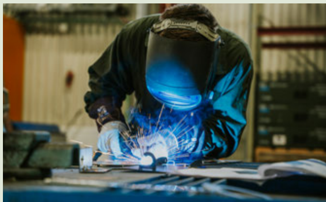
Eleverna använder en kombination av olika svetsmetoder för att bygga ihop kaminen.
