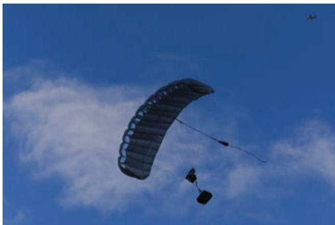
En gps-kontrollerad styrenhet ser till att lasten som hänger under skärmen landar på rätt ställe i terrängen.
