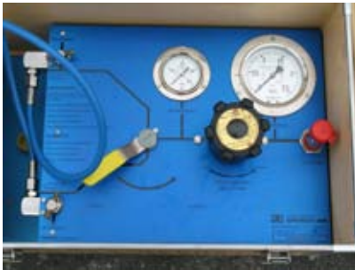
Bild 8.4. Fördelningslåda med utrustning för ytgas till lyftsäcken. (Foto: Försvarsmakten Michael Elsberg)
