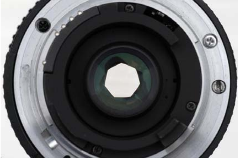
Bild 7.18. Ett objektivs bländaröppning. (Foto: Försvarsmakten Joakim Tenglin)
