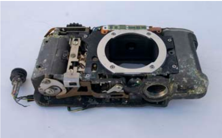
Bild 7.41. Innanmätet av en ärgad dränkt Nikonos V. Dränkt elektronik kan ibland räddas och repareras. Inledningsvis bör föremålet läggas i rödsprit för att få bort all fukt och saltrester. (Foto: Försvarmakten Joakim Tenglin)
