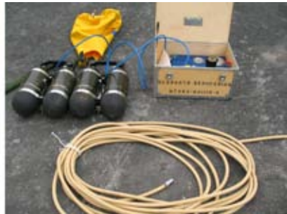
Bild 8.4. Fördelningslåda med utrustning för ytgas till lyftsäcken. (Foto: Försvarsmakten Michael Elsberg)
