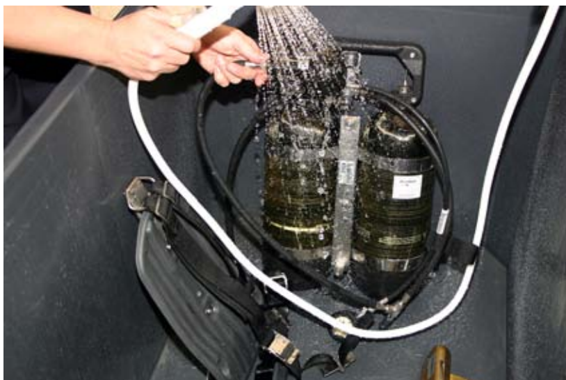
Bild 2.20. Apparaten ska vara trycksatt vid avsköljning. (Bild från FMV utbildningshandbok)
