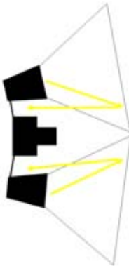
Bild 7.27. Lätt utåtriktade och något bakom portens glas får man bra belysning med blixstens kantljus. Detta minimerar "backscatter" även vid partikelrikt vatten. (Skiss: Försvarmakten Joakim Tenglin)
