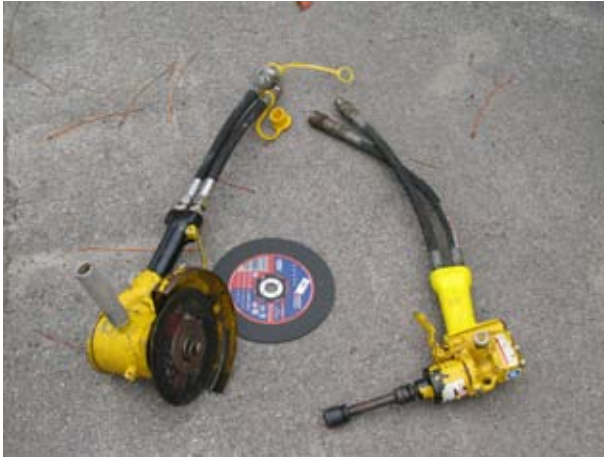
Bild 8.18. Hydraulisk slipmaskin samt en hydraulisk mutterdragare (dessa har en knapp så att du kan vända riktningen – lossa/skruva fast). (Foto: Försvarmakten Michael Elsberg)
