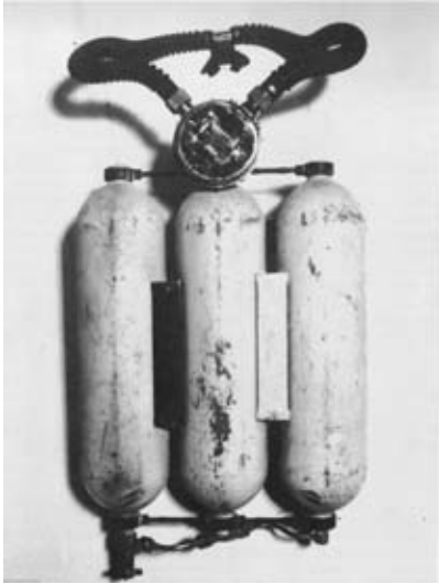
Bild 14.13. Bilden visar den apparat som Cousteau och Gagnan konstruerade under slutet av fyrtiotalet. De tre flaskorna var avsedda att ge dykaren tillräcklig volym luft då man sällan kunde få den fylld och framförallt inte till något högt tryck. (Historical Diving Times av Historical Diving Society England.)
