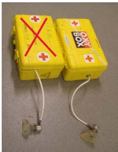
Bild 11.3. Oxyboxen till höger visar hur man ska koppla slangen genom genomföringen i väskan. (Foto: Försvarsmakten Johan Swahn)
