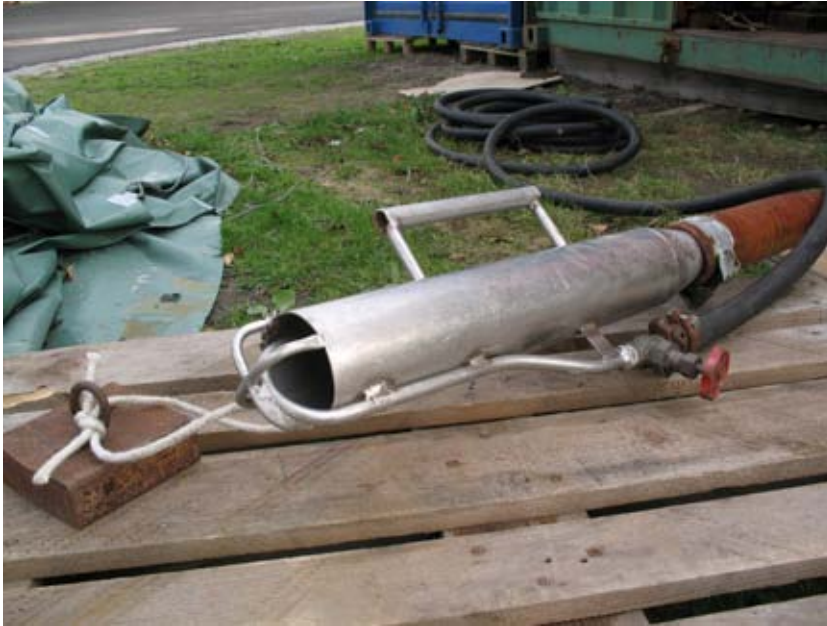
Bild 8.8. Mammut sug med tyngd. (Skiss: Autotech)
