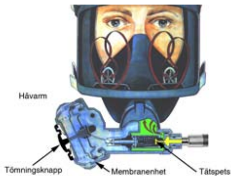
Bild 2.17. Principskiss över andningsventilen vid inandning (Bild från FMV utbildningshandbok)
