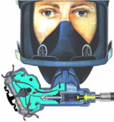
Bild 2.18. Principskiss över andningsventilen vid utandning. (Bild från FMV utbildningshandbok)
