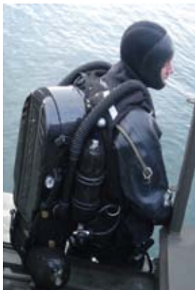
Bild 4.3. Exempel på ett halvslutet dyksystem. (Foto: Interspiro)
