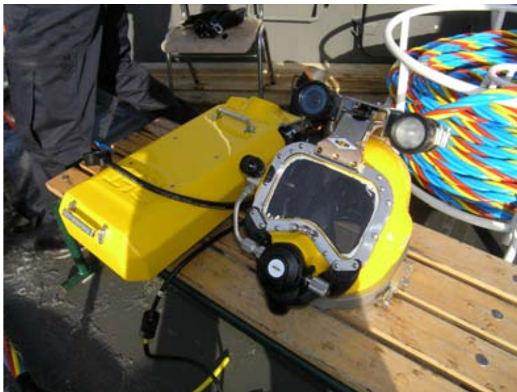
Bild 3.1. hjälm och nöddapparat till SLT 60. (Foto: Försvarmakten Joakim Tenglin)
