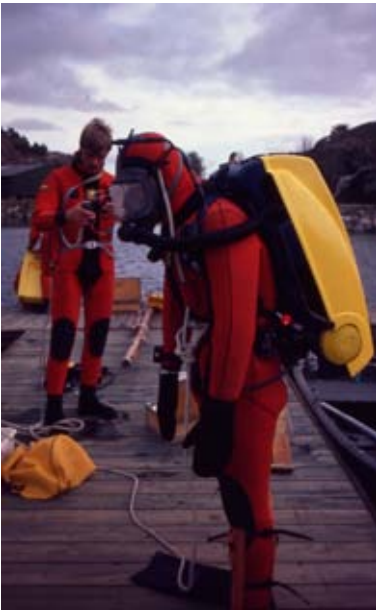
Bild 14.20. En Röjdykare med den variabla volym dräkten UNISUIT provar den helt nya röjdykarapparaten ACSC tillverkad av AGA (Numera Interspiro). Bilden troligen från sent sjuttioal. (Från Svensk Dykerihistorisk Förening.)
