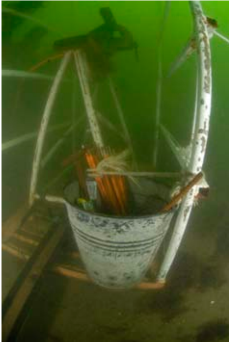
Bild 8.28. Verktygspyts kan med fördel nyttjas, då blir det en säker nedfiring av verktyg till dykaren. (Foto: Försvarmakten Joakim Tenglin)
