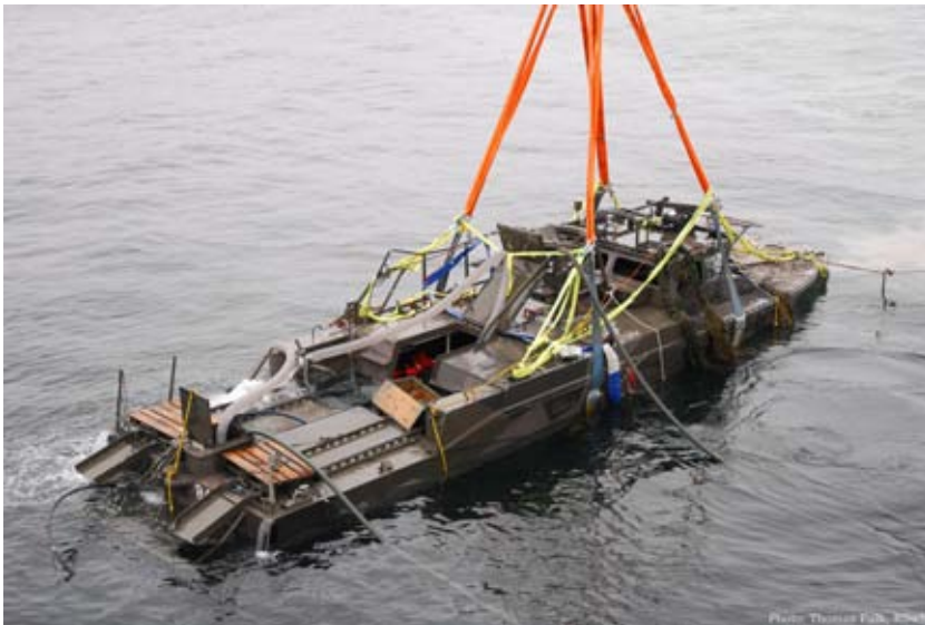
Bild 8.2. Bärgning med lyftstroppar. (Foto: Försvarmakten Thomas Falk)
