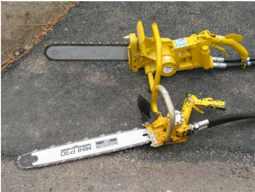
Bild 8.19. Hydraulisk diamantkedjesåg för kapning av betong/armerad betong och under den en hydraulisk kedjesåg för kapning av trä. Det är viktigt att sågar har ett parer/kastskydd och att kedjan inte är för slack (risk för brott och kast). Det finns alltid en risk att sågen slår mot dykaren. (Foto: Försvarmakten Michael Elsberg)
