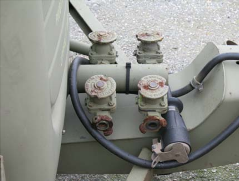
Bild 8.25. Uttagen sitter oftast utanpå, 4 st. inkopplingar för att leda ned lågtrycksluft via luftslangar med bajonettfattning. (Foto: Försvarmakten Michael Elsberg)
