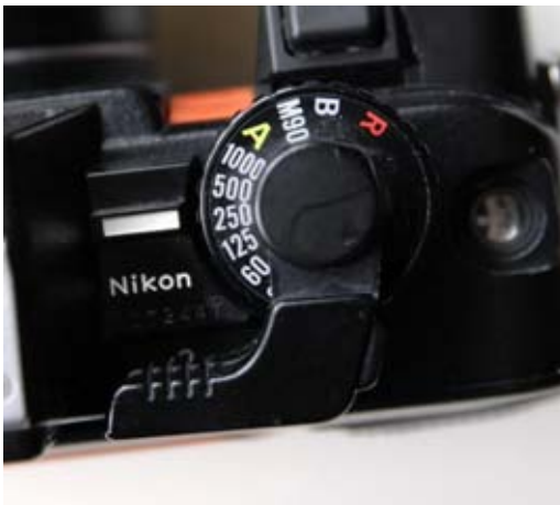
Bild 7.17. Kamerans väljarratt för slutartid. (Foto: Försvarmakten Joakim Tenglin)
