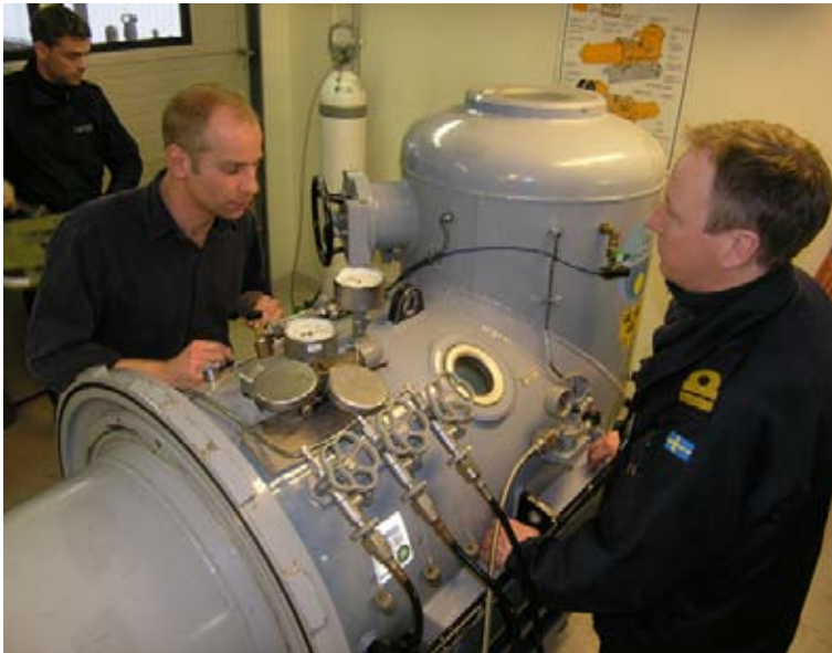
Bild 11.7. Dykarledare och tryckkamaroperatör vid rekompresionsbehandling med Duocom. (Foto: Försvarmakten Joakim Tenglin)
