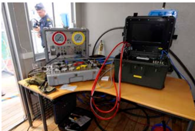
Bild 3.3. Dykarledarens panel till SLT 60 . (Foto: Försvarmakten Joakim Tenglin)
