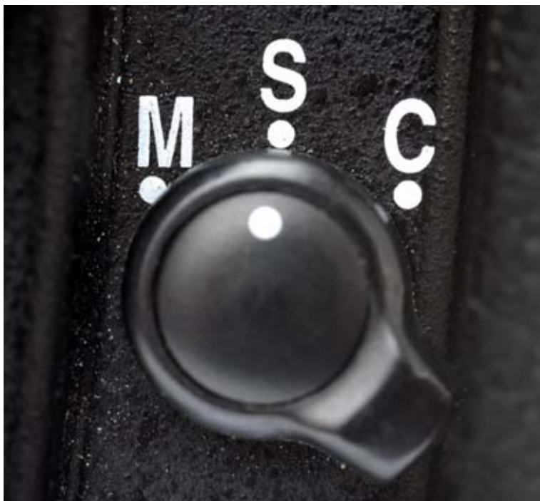
Bild 16. Fokusinställning. Manuell, Single servo och Continuous fokus. (Foto: Försvarmakten Joakim Tenglin)
