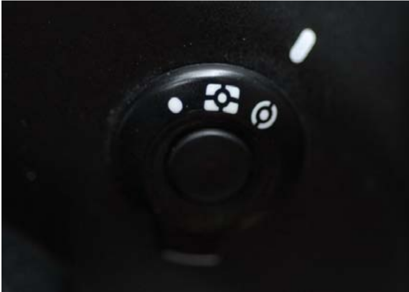
Bild 7. Ljusbätningsalternativ på en Nikon SLR. (Foto: Försvarsmakten Joakim Tenglin)
