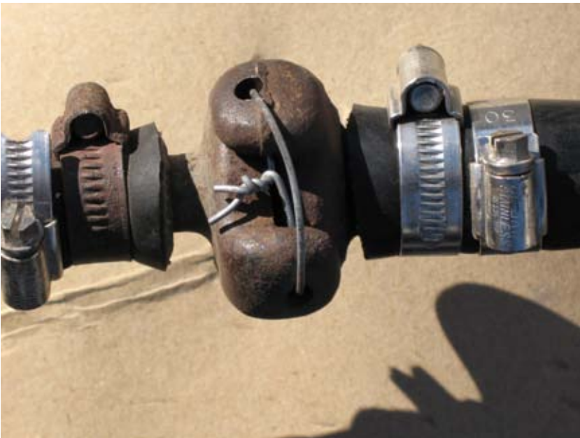
Bild 8.26. Bilden visar hur man har säkrat bajonettinkopplingarna till varandra med stål/najtråd. Kontrollera slangen inför användandet, om den har sprickor, är klämd eller annan skadlig påverkan ska den kasseras. (Foto: Försvarmakten Michael Elsberg)
