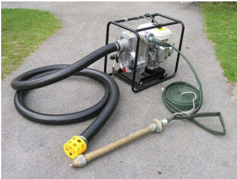
Bild 8.7. Motorspruta med spolmunstycke. (Foto: Försvarmakten Michael Elsberg)
