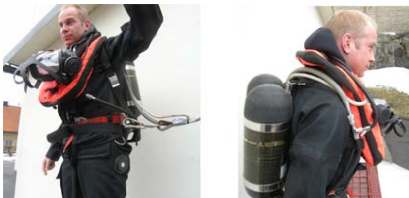
Bild 2.21. Bilder på kopplad gasförsörjning från ytan. (Foto: Försvarmakten Joakim Tenglin)
