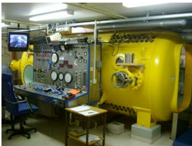
Bild 10.2. Fleravdelningstryckkammare med personalsluss och medicinluss. (Foto: Försvarmakten Joakim Tenglin)
