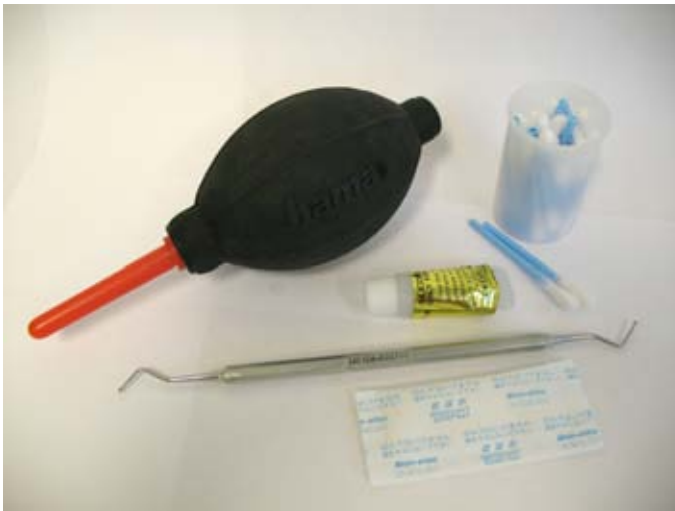
Bild 7.40. Låsbälg, oringsplockare, silikonfett, tops. (Foto: Försvarsmakten Joakim Tenglin)
