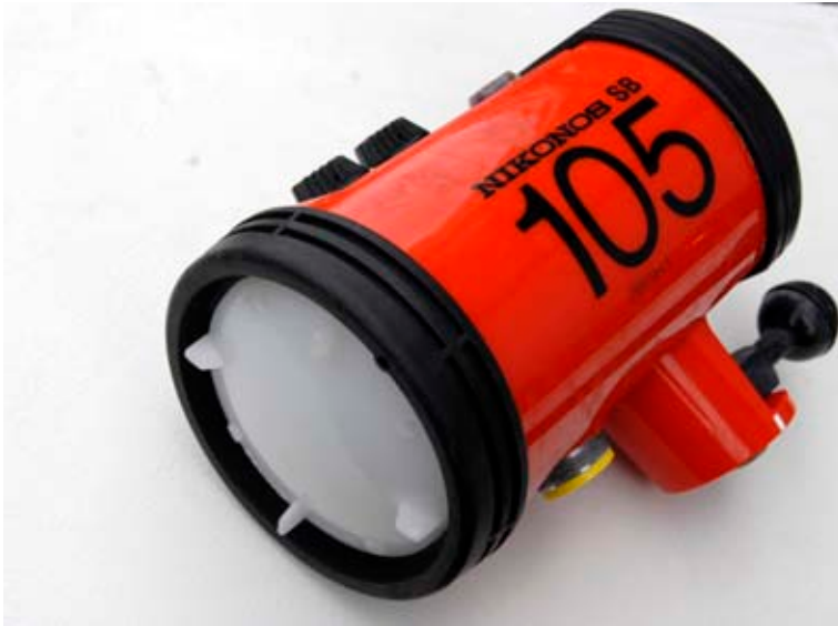
Bild 7.28. Diffusorn sprider ljuset jämnare och är framförallt bra för vidvinkel situationer. (Foto: Försvarmakten Joakim Tenglin)
