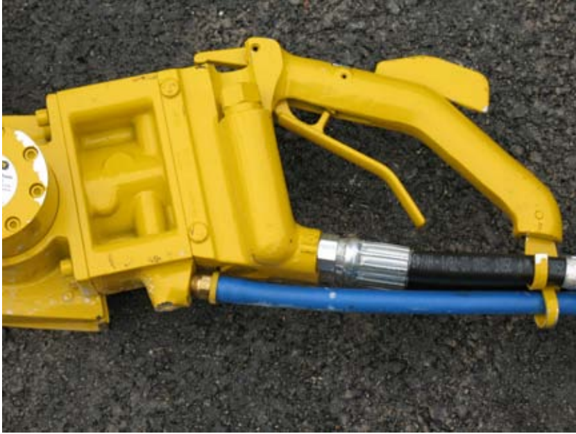
Bild 8.22. Hydraulisk diamantkedjesåg för betong/armerad betong. Den blå slangen är kopplad till vatten för att kunna föra bort slagg. Den är utrustad med ett "död mans grepp", som alltid ska kontrolleras före användande. (Foto: Försvarmakten Michael Elsberg)
