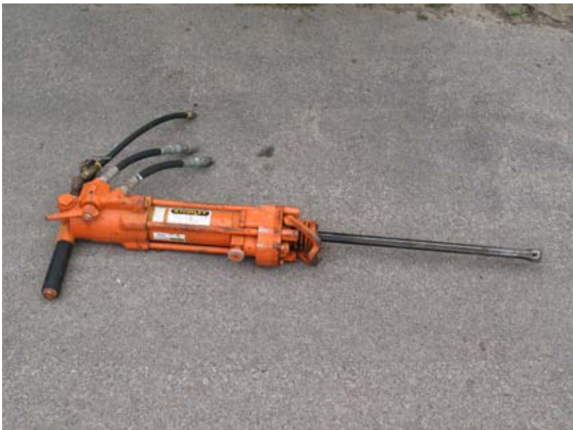
Bild 8.23. Hydraulisk bergborrmaskin. Observera att den har tre slangar, en olja tillopp, en olja retur och en lågtrycksluft för att blåsa rent slagg s k borrkax. (Foto: Försvarmakten Michael Elsberg)
