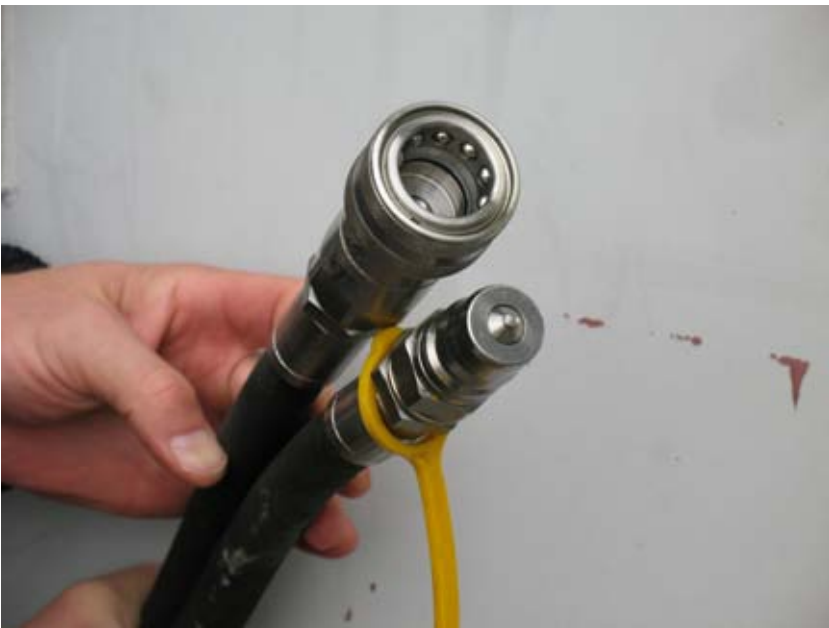
Bild 8.21. Tillrops- och returslang med hane/honkoppling, när man kopplar ihop dem se till att de är säkrade så att de inte separerar. Se till att hålla ändarna rena och när man inte använder dem ska det sitta en skyddshatt på dem. (Foto: Försvarmakten Michael Elsberg)
