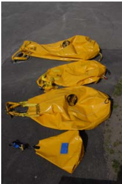
Bild 8.3. Lyftsäckar med olika lyftkapacitet (Foto: Försvarsmakten Joakim Tenglin)
