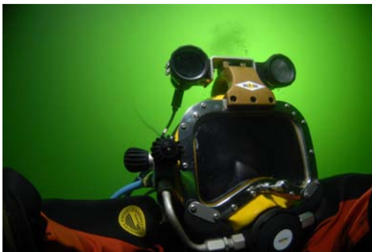
Bild 7.33. SLT 60 dykare med Genesishjälm och realtidsvideo. (Foto: Försvarmakten Joakim Tenglin.)
