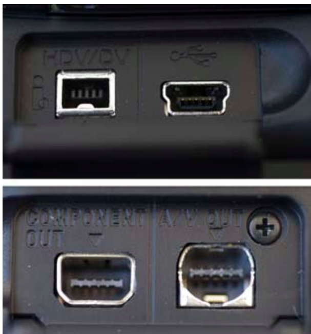
Bild 7.38. Utgångskontakter HDV kamera. (Foto: Försvarmakten Joakim Tenglin)
