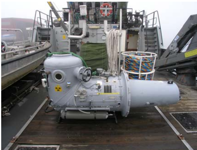
Bild 10.1. Transportabel enavdelningskammare med medicinluss (Duocom) (Foto: Försvarmakten Joakim Tenglin)
