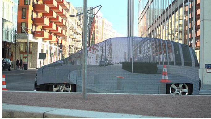
Figur 6 En bil täckts med LEDs som används för att projicera bakgrundscenen på fordonet 20
