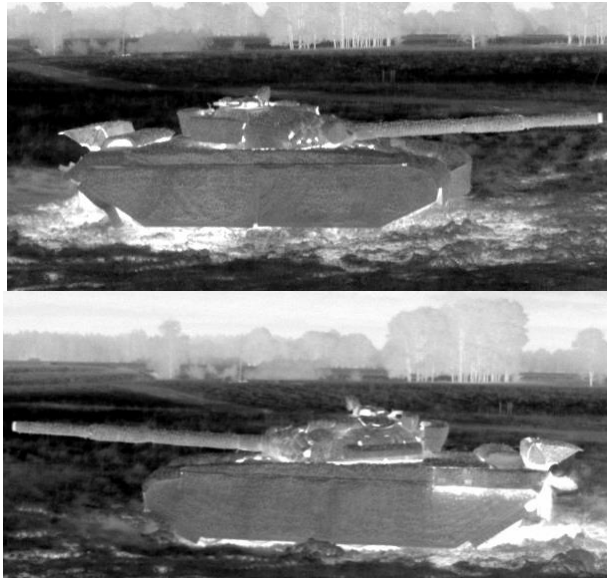
Figur 19 MWIR- signatur av varmkörd T-72 stridsvagn med MCS, överst visas höger sida, undre bilden visar vänster sida.
