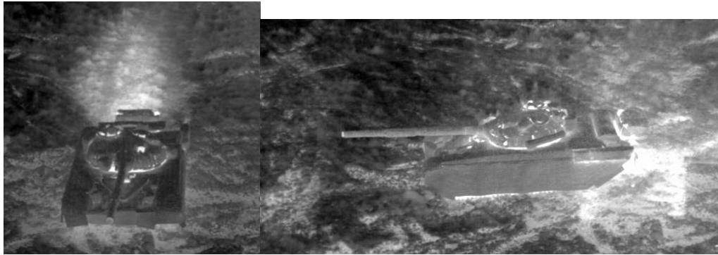
Figur 21. MWIR- signatur av varmkörd stridsvagn med MCS. Marken har värmts upp kring vagnen, speciellt bakom.
