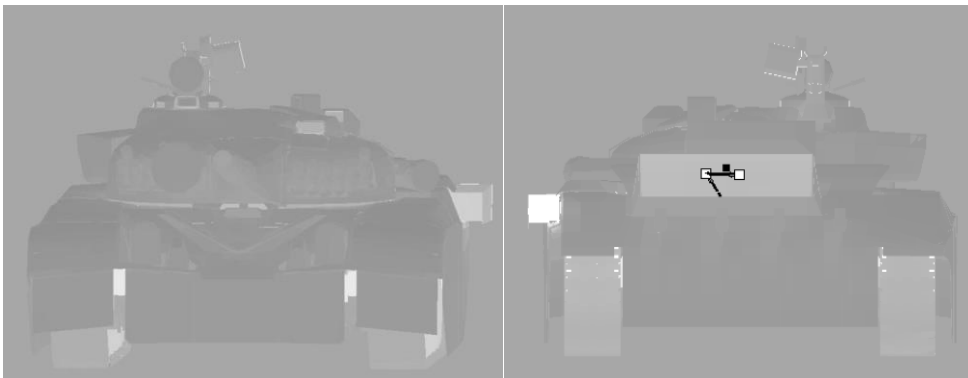
Figur 18. Temperaturfördelning beräknad med TAIthermIR för varmkörd T-72 stridsvagn med MCS, t.v. framifrån samt t.h. bakifrån. (Skalan är densamma som tidigare figur). Anm. Markörer för varmluftsblås ligger tyvärr kvar i figuren
