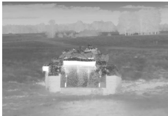
Figur 24. LWIR- signatur från varmkörd T-72 stridsvagn sett bakifrån, i stort sett samma skala som i föregående bild.
