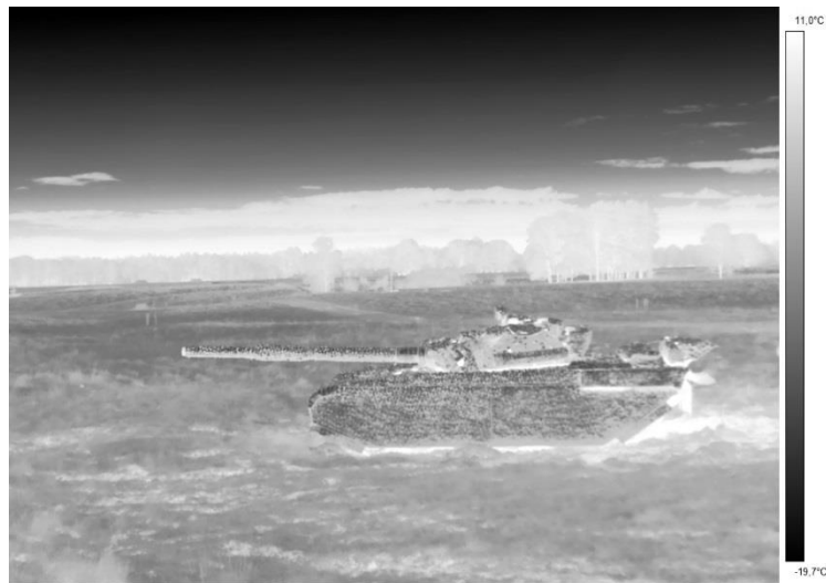
Figur 22. LWIR- signatur från varmkörd stridsvagn sett från höger sida.
